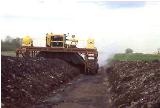
Mehanizovano mešanje komposta u toku fermentacije organske materije
