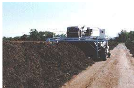
Mehanizovano mešanje komposta u toku fermentacije organske materije
